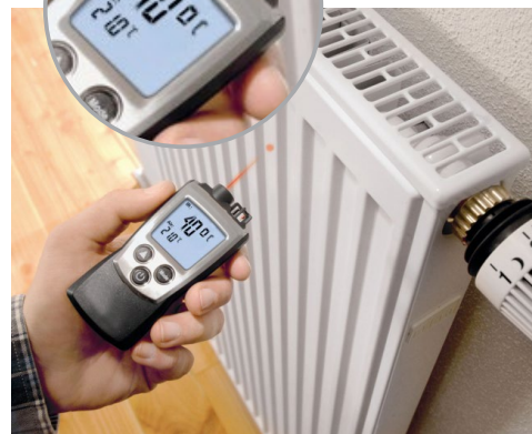
Verifica con termometro con puntatore laser
